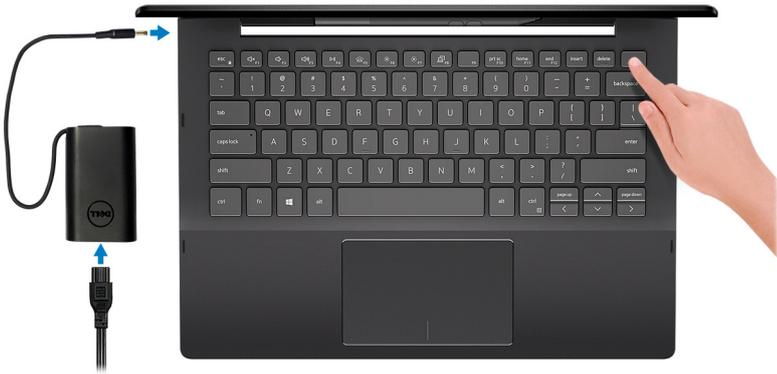
**注：**为了节省电池电量，计算机可能进入省电模式（睡眠状态）。打开电源适配器，并按电源按钮以打开计算机。
